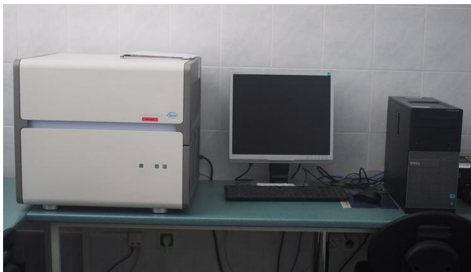
Obrázek 39: Termocykler LightCycler®480II s příslušenstvím Fotografie pořízena autorkou práce na OLM KNTB a.s. Zlín
