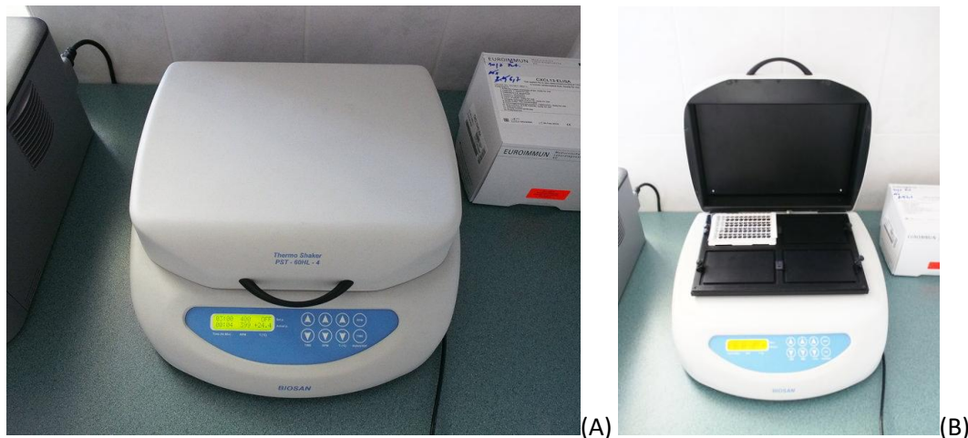
Obrázek 26: A – třepačka BIOSAN Ltd., Lotyšsko, B - mikrotitrační destička na třepačce Fotografie pořízeny autorkou práce na OLM KNTB a.s. Zlín
