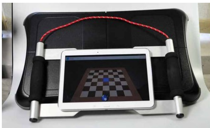
Obrázek č. 8: Systém Homebalance - tenzometrická plošina, tablet a terapeutická scéna (Zdroj: Janatová et al., 2016)
