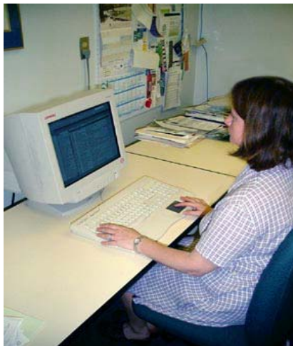
Obr.č.: 28 Speciální klávesnice s dotykovou ploškou (převzato z:Canadian Centre for Occupational Health and Safety z www: /http://www.ccohs.ca/oshanswers/ergonomics/office/mouse/mouse_location.html )
