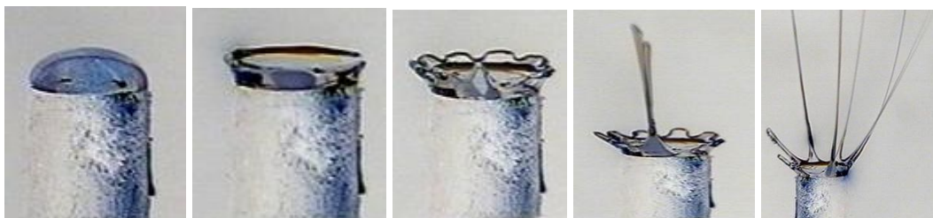
Obrázek 13: Tvorba Taylorových kuželů a vymrštění polymeru 54
