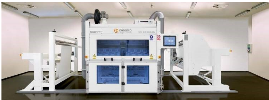
Obrázek 20: Nanospider™ v šíři 1,6 metru pro průmyslovou výrobu nanovláken 54
