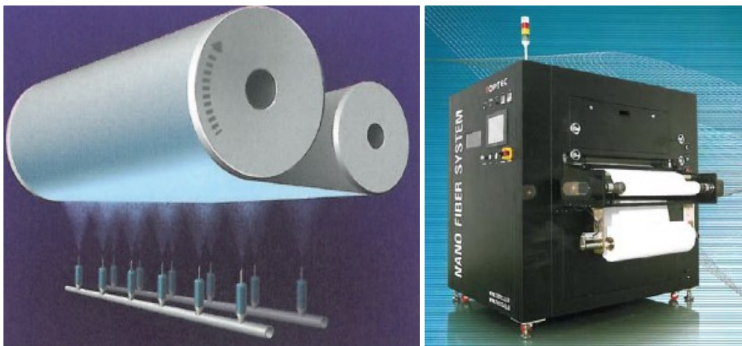
Obrázek 16: Znázornění procesu a zařízení TOPTEC elektrospinningu 63
