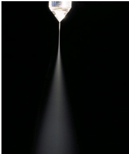
Obrázek 12: Taylorův kužel a proud roztoku polymeru 52
