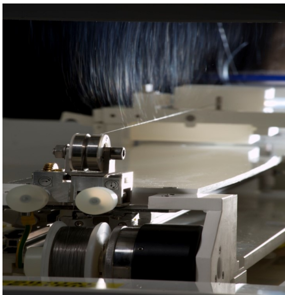
Obrázek 19: Druhá generace zařízení pro proces zvláknování vyvinutá ve firmě ELMARCO 2010 54
