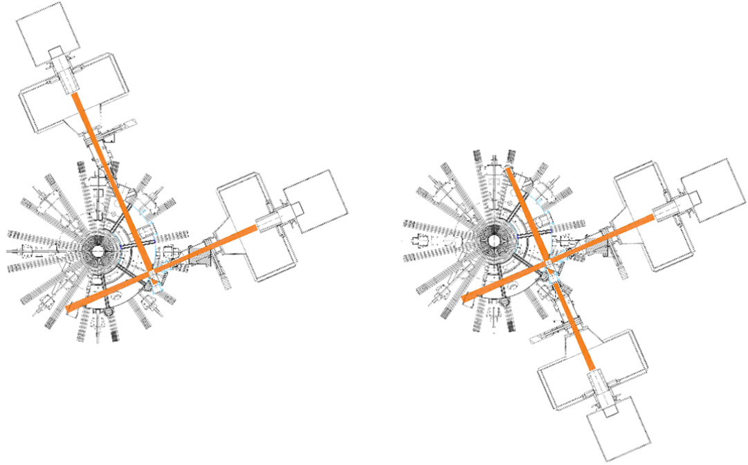
Obrázek 3.4: Schématické uspořádání vstřiku vysokoenergetických svazků (NBI systémy) - pohled shora. Vlevo: vstřik ve směru proudu plazmatem. (tzv. co-injection) Vpravo: Vyvážený vstřik NBI svazků (tzv. balanced injection).
