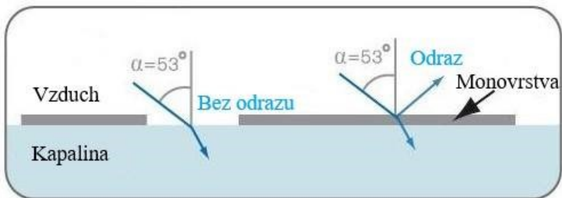
Obrázek 10. Lom paprsku na rozhraní dvou prostředí (vzduch/kapalina) a jeho odraz od monovrstvy.
