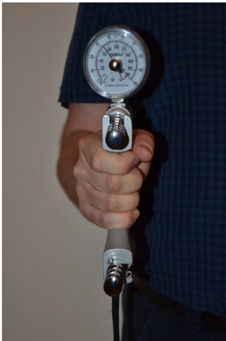
Obrázek 2: Dynamometr firmy JAMAR (zdroj: foto autorka)
