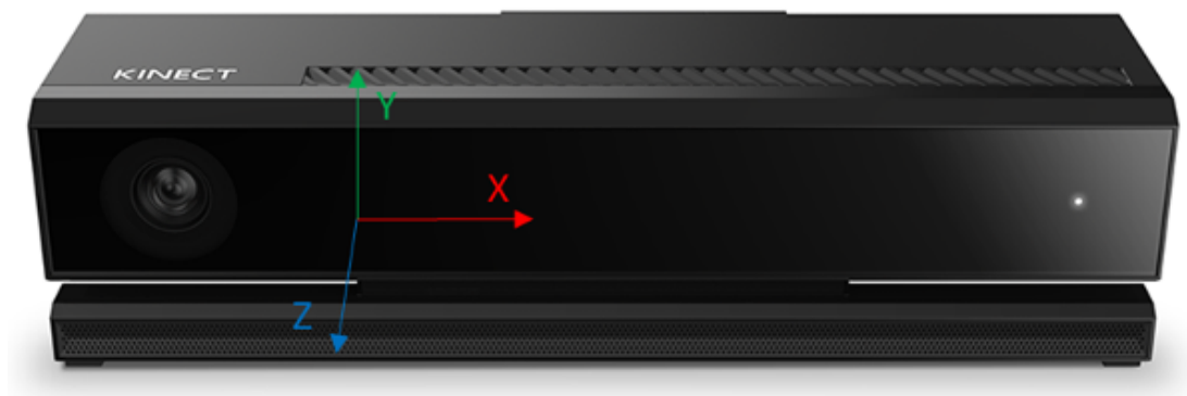
Obr. 2.1: Microsoft Kinect v2 s osami snímania dát. Zdroj: Microsoft.
