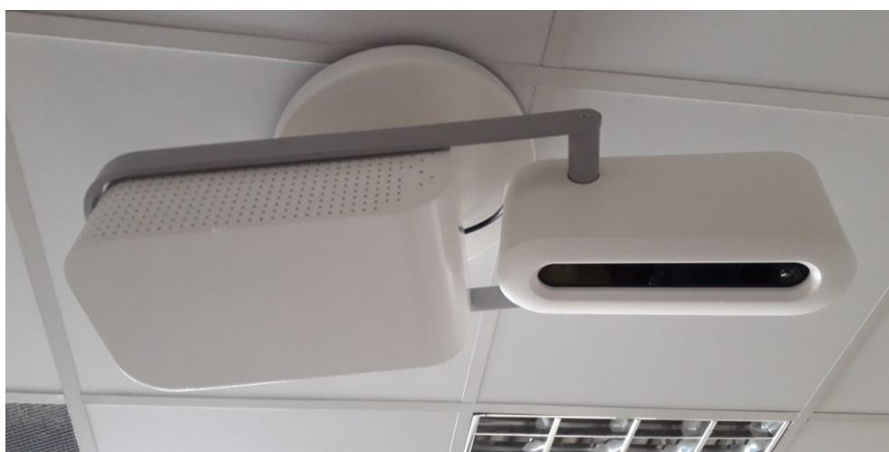
Obrázek 4 – Integrovaná 3D kamera nad vyšetřovacím stolem pro správnou centraci pacienta
