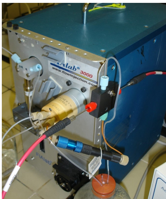
Obrázek 6 - Detail prvního systému SIC na bázi standardního přístroje SIA.
