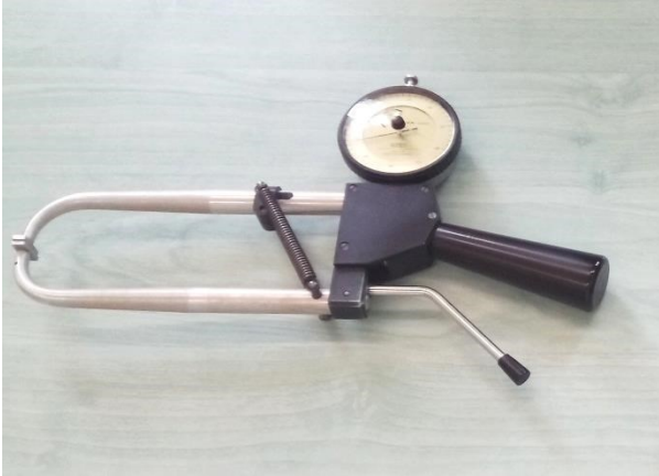
Obrázek 1 - Ukázka mechanického přístroje určeného k měření tloušťky kožní řasy (zdroj: vlastní; foto: autor)
