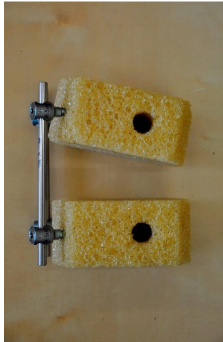
Obrázek 15. Selhání soustavy uvolněním transpedikulárního šroubu z PUR bloku tzv. „windshield wiper“ efekt.
