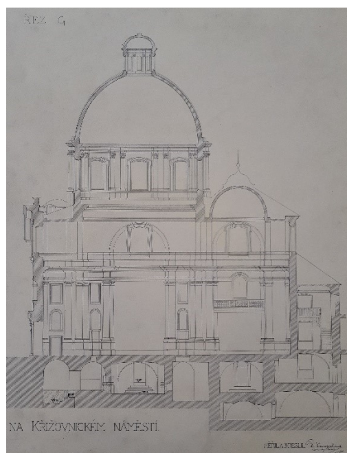
47. Řez v bokorysu kostela sv. Františka, s vyznačením výšky niveau
