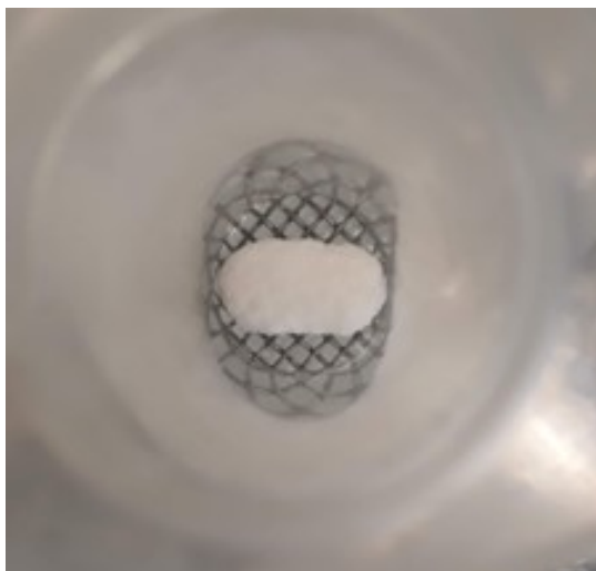
Obr. 29: Tableta T_{LKP5,4} na dně trubice přístroje po vytažení z vody.
