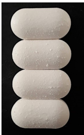
Obr. 28: Hrbolky na povrchu tablet s krospovidonem.
