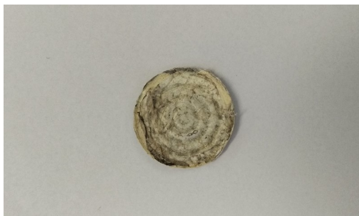
Obrázok 10: PID nanovlákná po poťahovaní v online systéme
