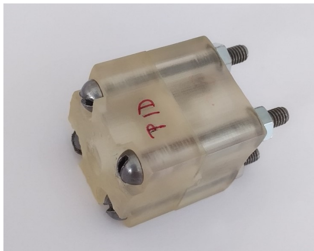
Obrázok 8: Držiak vyrobený 3D tlačou
