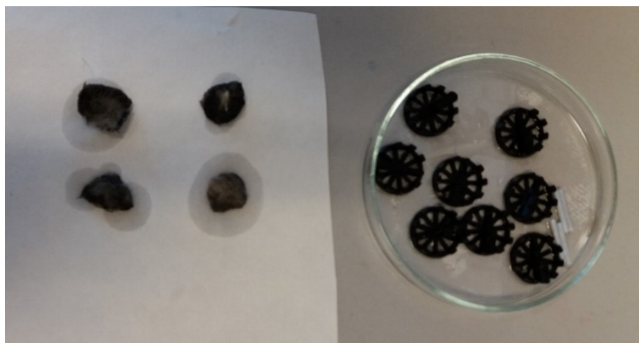
Obrázok 9: PCL nanovlákná po poťahovaní v batch protokole
