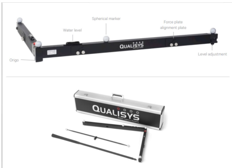
Obrázek 33 – Umístění markerů na kalibračním rámu a na kalibrační hůlce
