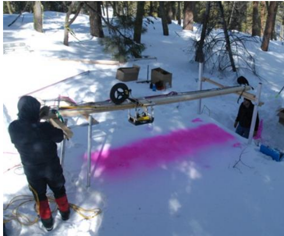
Obrázek 8: Provedení zadešťovacího experimentu rámci studie preferenčních cest ve svažitém terénu. Zdroj: Eiriksson et al. 2013
