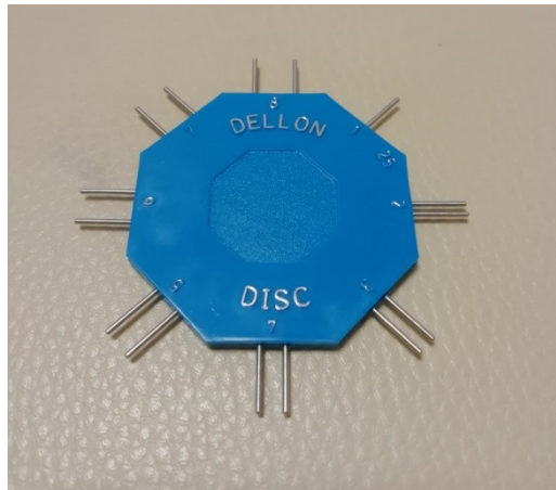
Obrázek 6 Dvoubodový diskriminátor (zdroj: vlastní)
