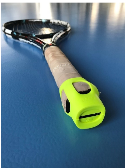
Obrázek č. 1 a 2: Uložení senzoru Zepp Tennis a výsledné hodnoty v mobilní aplikaci
