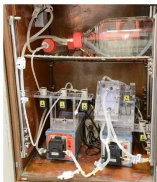
Obrázek 5 - schématické znázornění systému na decelularizaci tkání a jeho instalace v temperované komoře.
