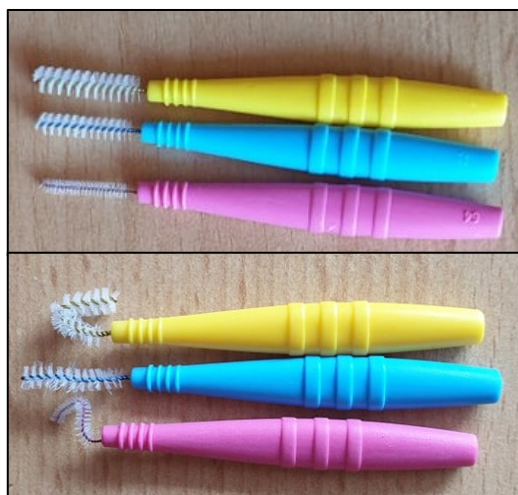
Obr. 108 - Porovnání odolnosti mezizubních kartáčků před a po zkoušce odolnosti drátku
