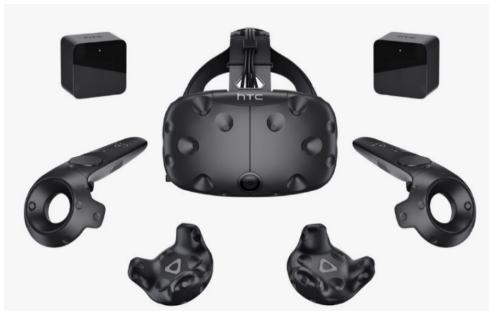
Obrázek č. 1: Platforma HTC Vive, headset, controllery, trackery a lighthouses
