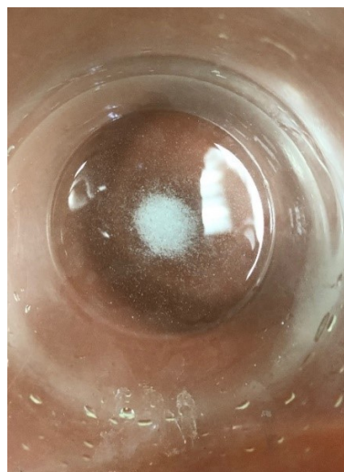
Obrázek 32: Zbytek na dně disoluční nádoby po tabletě s KP
