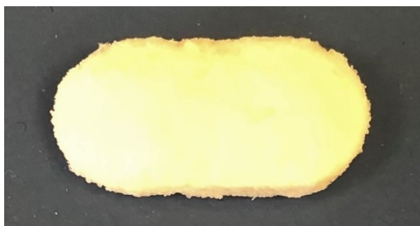
Obrázek 30: Tableta šarže T_{LKP5,4} po ukončení disolučního testu
