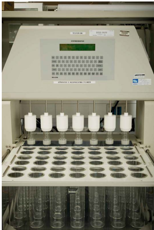
Obrázek 9: Přístroj 3 s vratným válcem, detail vratného válce 52
