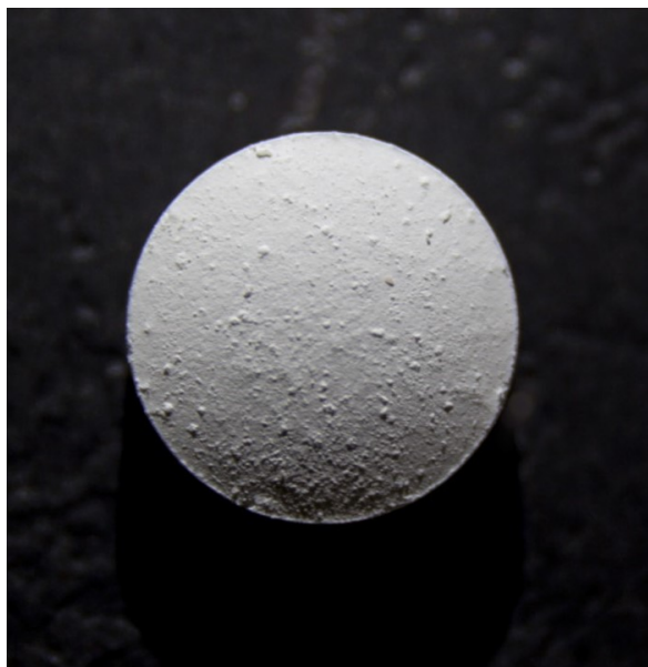
Obrázek 5: Povrchové defekty tablety s kroskovidonem (dle Hiew a kol.) 45
