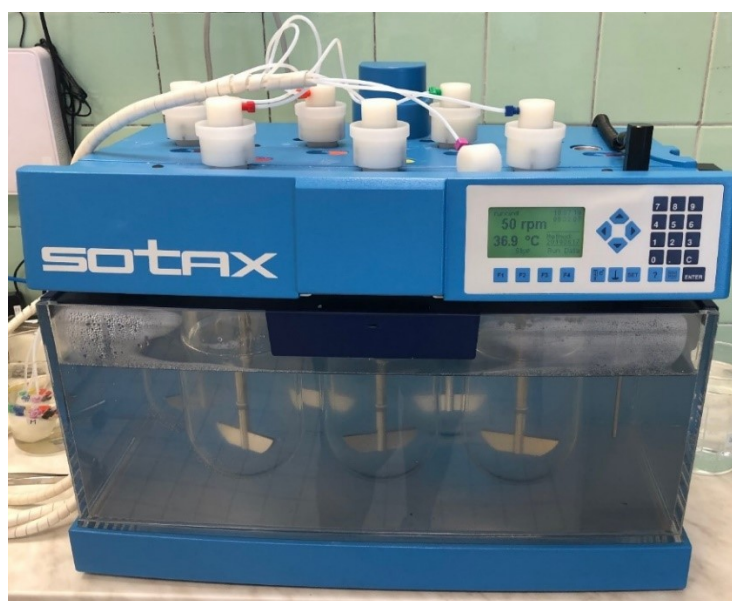
Obrázek 16: Disoluční přístroj SOTAX AT-7 Smart
