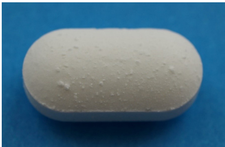
Obrázek 27: Tablety s KP s pozorovanou změnou vzhledu („hrbolky“)
