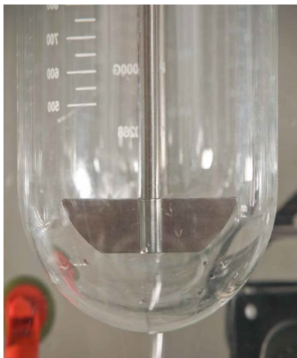
Obrázek 7: Přístroj 2 s míchadlem/pádlem 52
