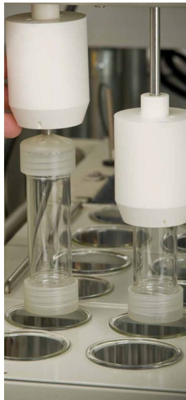
Obrázek 9: Přístroj 3 s vratným válcem, detail vratného válce 52
