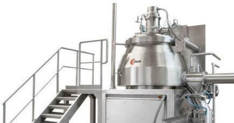
Obrázek 11: Vysokosmykové granulační zařízení Glatt VG-50 62
