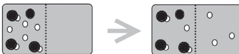
Obr. 10 – Schematické znázornění rovnovážné dialýzy (převzato [1])
