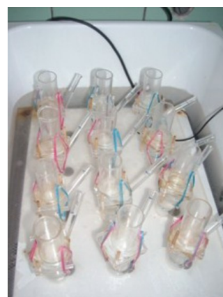
Obrázek 14: Schema Franzovy difúzní cely a sestava Franzových permeačních cel ve vodní lázni
