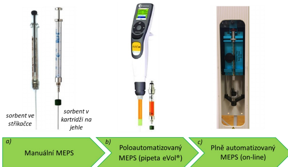
Obrázek 4: Mikroextrakce pomocí plněného sorbentu (a) manuální – sorbent umístěn ve stříkačce nebo v kartridži na jehle, (b) poloautomatizovaná pomocí pipety eVol a (c) plně automatizovaná. Převzato a upraveno podle [77, 79].
