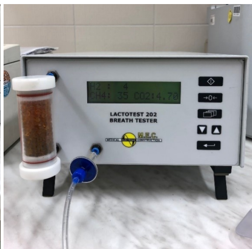
Obrázek 6 - MEC Lactotest202 Xtend s připojeným vakem během analýzy; Obrázek 7 - Lactotest s detailem displeje a hodnotami H 2 , CH 4 a CO 2 během analýzy vzorku vzduchu
