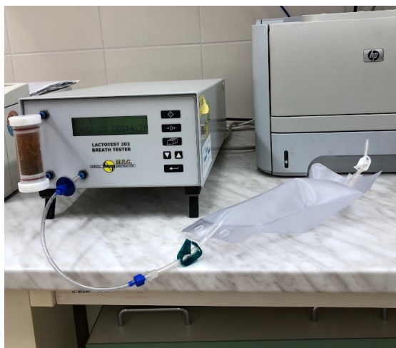
Obrázek 6 - MEC Lactotest202 Xtend s připojeným vakem během analýzy; Obrázek 7 - Lactotest s detailem displeje a hodnotami H 2 , CH 4 a CO 2 během analýzy vzorku vzduchu
