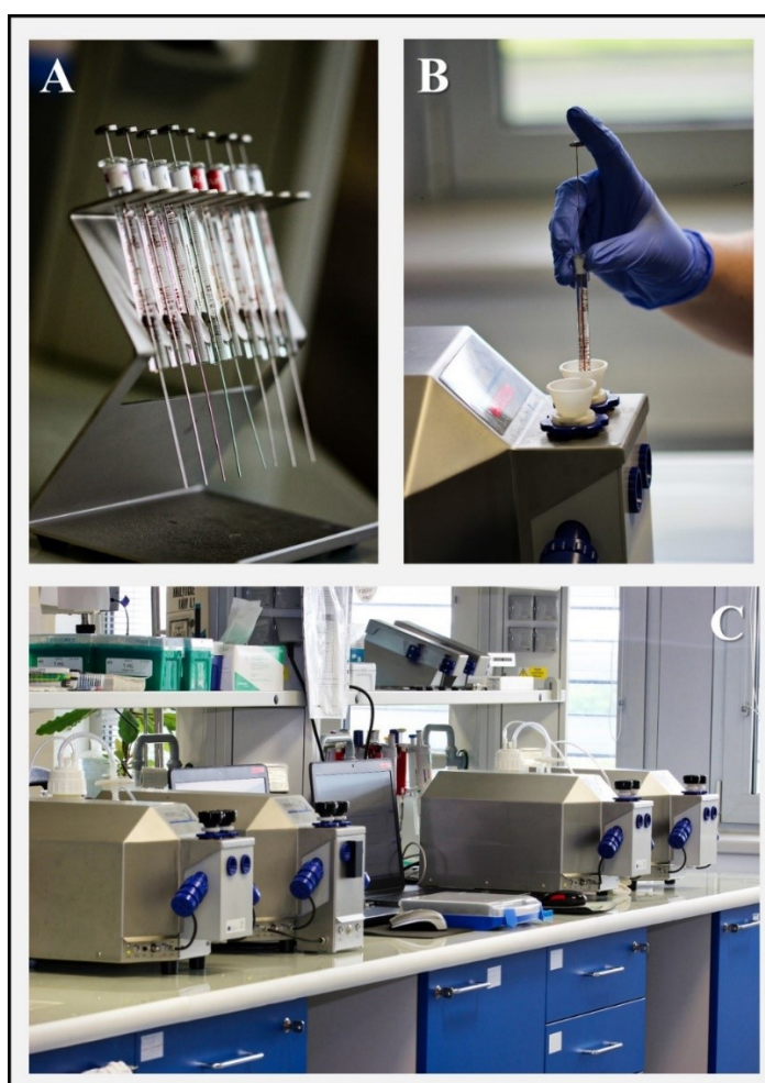
Obrázek 16. Vybavení pro měření mitochondriální respirace. A) Hamiltonovy injekční mikrostříkačky různých objemů pro přesné titrování přidávaných substrátů, inhibitorů a dalších látek v průběhu měření mitochondriální respirace v přístroji Oxygraph-2k. B) Postup titrace látky do komory O 2 k pomocí Hamiltonovy injekční mikrostříkačky. Po propláchnutí a naplnění daným objemem přidávané látky je mikrostříkačka vložena do kapiláry ve stopperu a objem pomalu stříknut do komory O 2 k tak, aby nedošlo ke vzniku nežádoucích bublinek plynu. C) Měření probíhalo současně ve 4 přístrojích Oxygraph-2k, tedy v 8 komorách (autor fotografií: MUDr. Lukáš Nalos Ph.D.).
