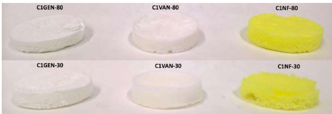
Obr. 28 Ukázka lyofilizátů s gentamicinem (GEN), vankomycinem (VAN) a nitrofurantoinem (NF) s koncentrací kolagenové disperze C1, zamražených na -30 a -80^{\circ}\text{C} .
