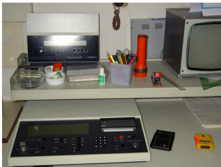
Obr.6. ovladovna microSelectronu HDR (vlevo nahoře: monitor nezávislého dozimetrického systému, vlevo dole: ovládací konzole, vpravo nahoře: monitor pro sledování pacienta)
