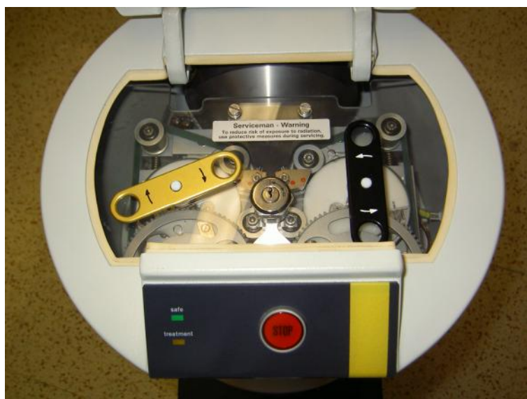
Obr.5 mechanismus vodičích lanek; zlatou kličkou je v případě nutnosti možno zatáhnout zdroj zpět do ozařovacího, černá klička je pro check-cable
