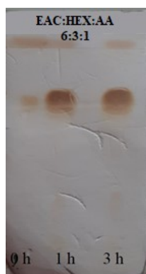
Obrázek 21. TLC záznam látky 11 v čase spuštění reakce, v době 1 h a v době 3 h. Soustava EAC:HEX:AA, 6:3:1.
