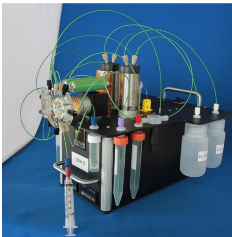
Obrázek 8 – Příklad průtokového systému SIA
