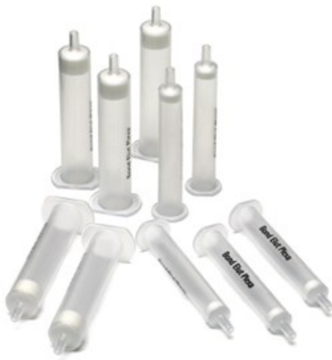
Obrázek 3 – Různé velikosti kolon se SPE sorbentem (jednorázová varianta používaná v offline systémech)
