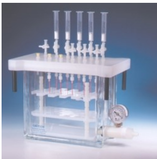
Obrázek 6 – Manuální provedení SPE extrakce s urychlením průtoku kapalin pod tlakem standardní provedení SPE mimo analytický systém
