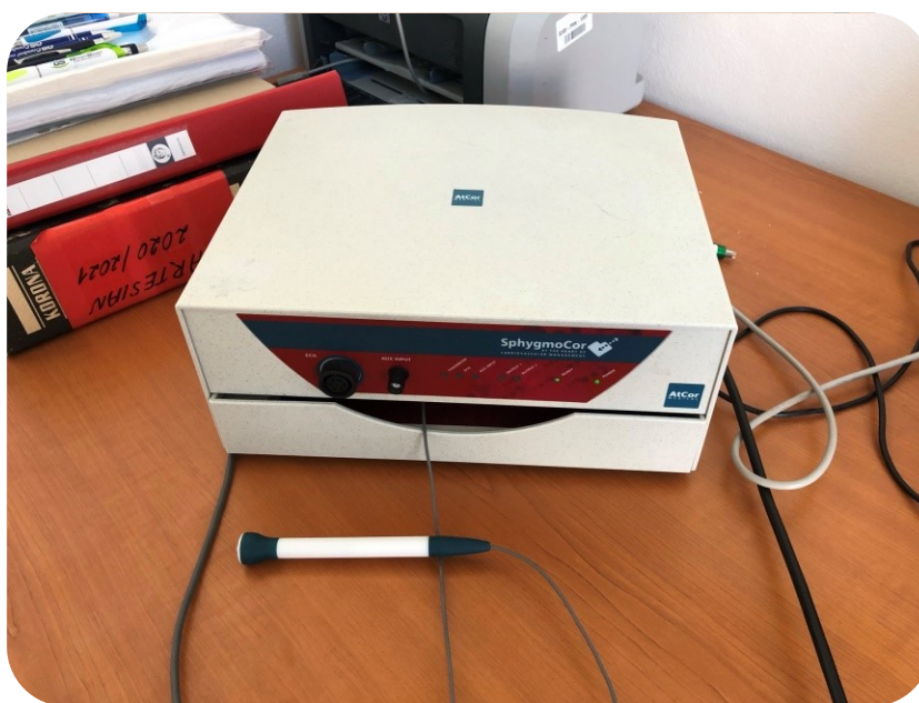
Obrázek 7 – Přístroj Sphygmocor MM3 použitý při neinvazivním měření aPWV.
