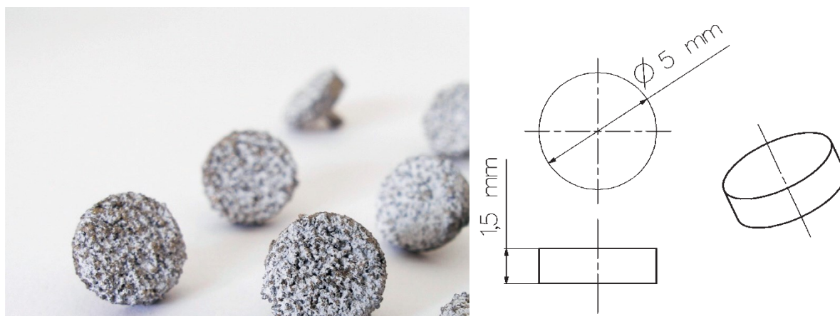
Obr. 1. Ukázka studovaných vzorků (vlevo) a jejich technický náčrt (vpravo).
