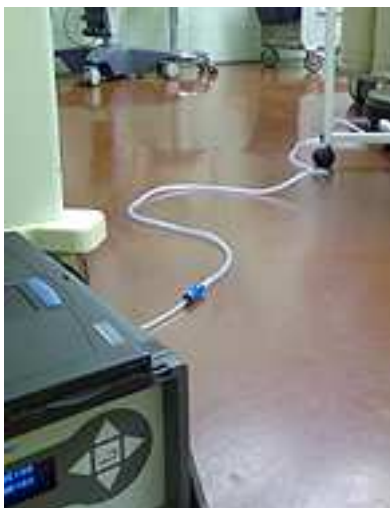
Obrázek 3.3: Vyvedení teflonové hadičky k místu měření
