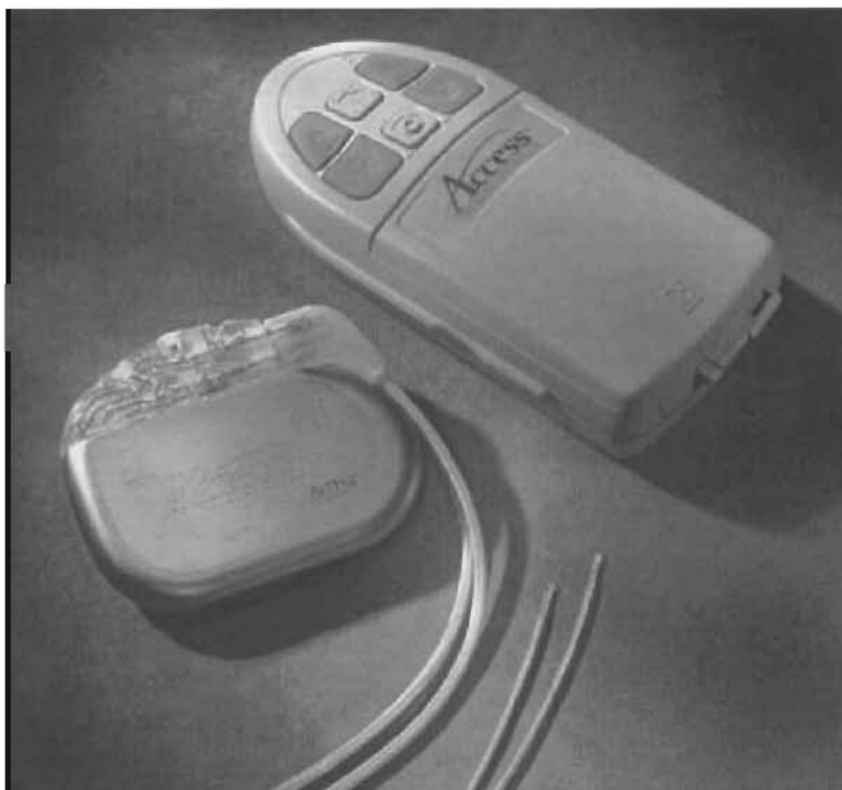
Obr. 4 – Generátor proudu s prodlužovacím kabelem a elektrodami. Pacientský ovladač s tlačítka na zvyšování (snižování) intenzity stimulace - amplitudy, tlačítka pro zapnutí a vypnutí generátoru.
