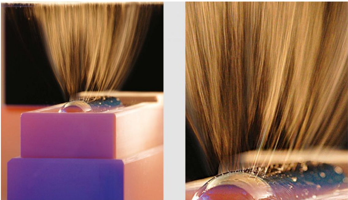
Obrázek 12 – Nánovlákná vznikající technologií NanoSpider™ [26]
