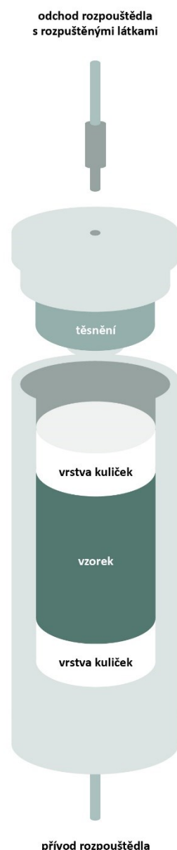
Obrázek 11: Průřez naplněnou extrakční celou
