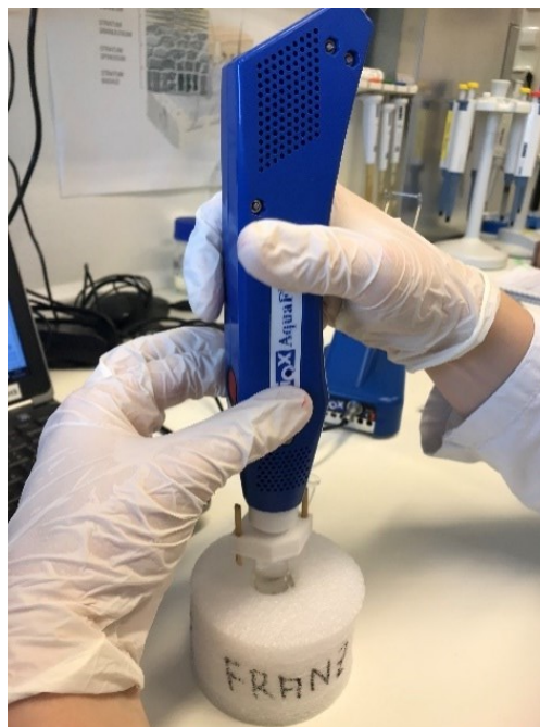
Obrázok 15 – Meranie straty vody modelových membrán pomocou prístroja AquaFlux.
