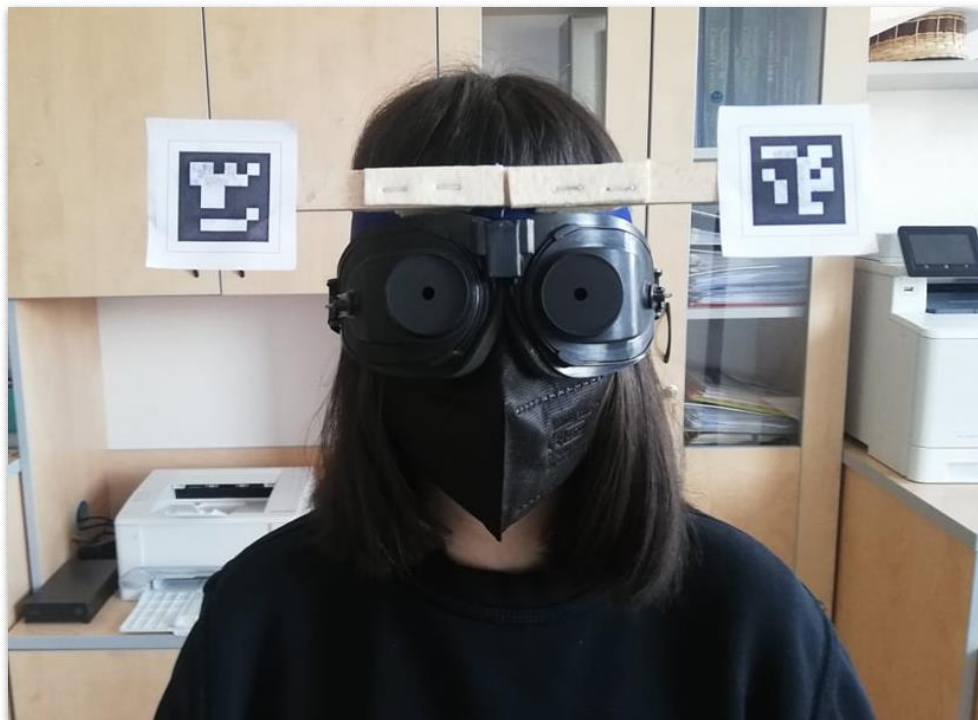
Obrázek 8 – Fotografie účastníka měření s ukázkou nastavení brýlí a čelenky s QR kódy pro měření úklonu hlavy
