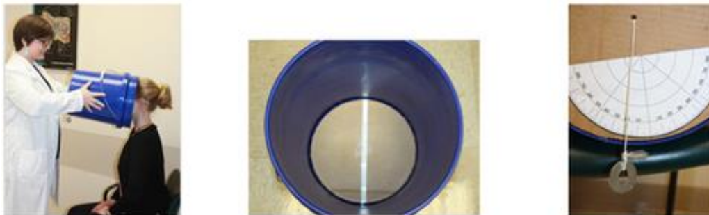
Obrázek 3 – Ukázka technického zpracování kbelíku a samotného procesu testování SVV (MICHELSON, 2018)
