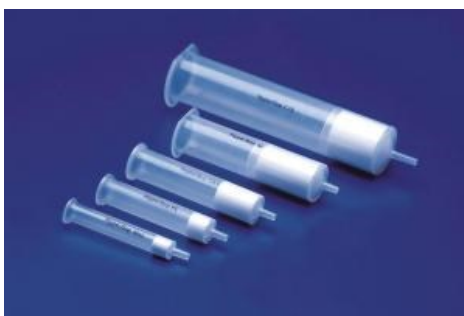
Obrázek 6 Ilustrace různých velikostí komerčních SPE kolonek.
