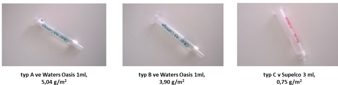
Obrázek 14 Manuálně plněné kolonky nanovláknovým sorbentem využívané pro off-line extrakce.
