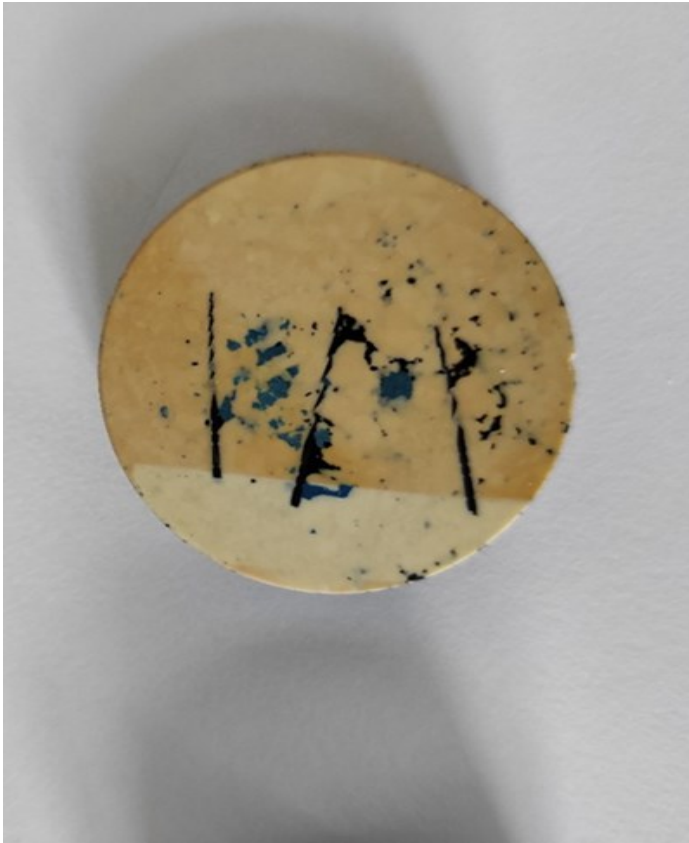
Obrázek 41 - Zalisované vzorky připravené na měření mikrotvrlosti Zdroj: vlastní
