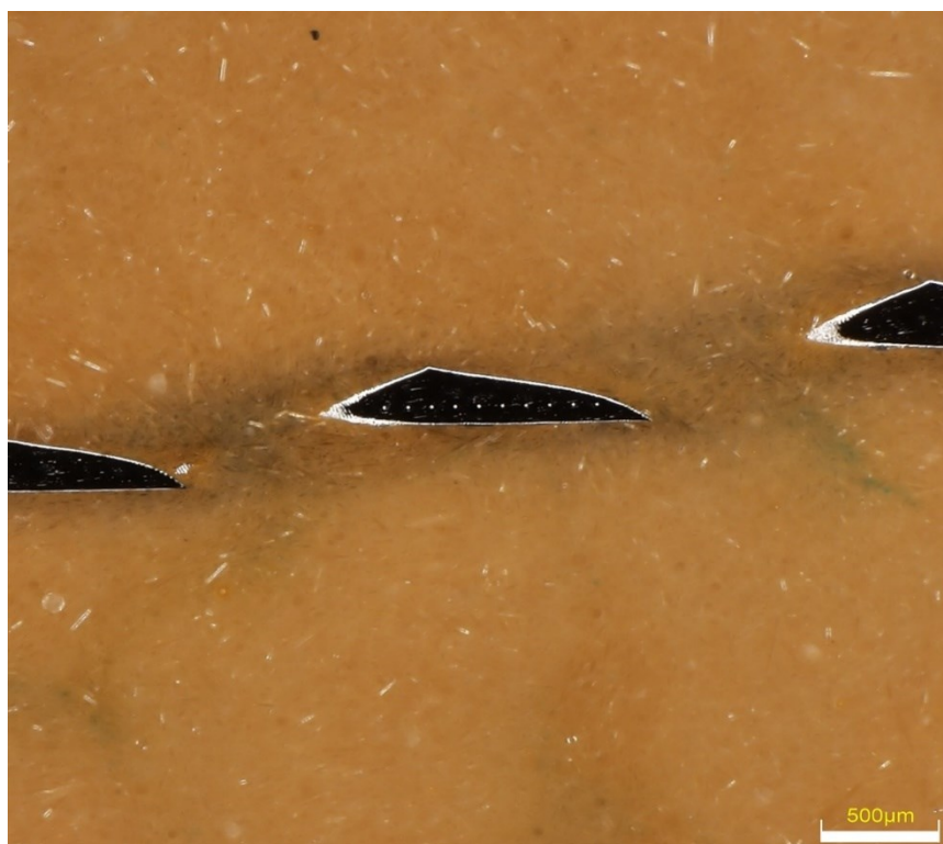
Obrázek 43 - Znázorněné vtisky po měření mikrotvrlosti na segmentu NiTi nástroje Zdroj: vlastní
