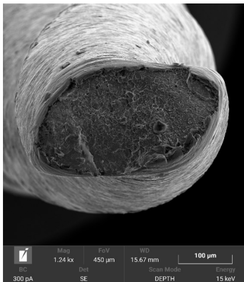
Obrázek 20 – Nástroj 15/0.5 po plazmové nitridaci – proces 2
