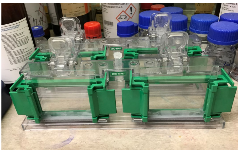
Obrázek 12 Polymerace separačního gelu převrstveného isobutanolem (Autor)
