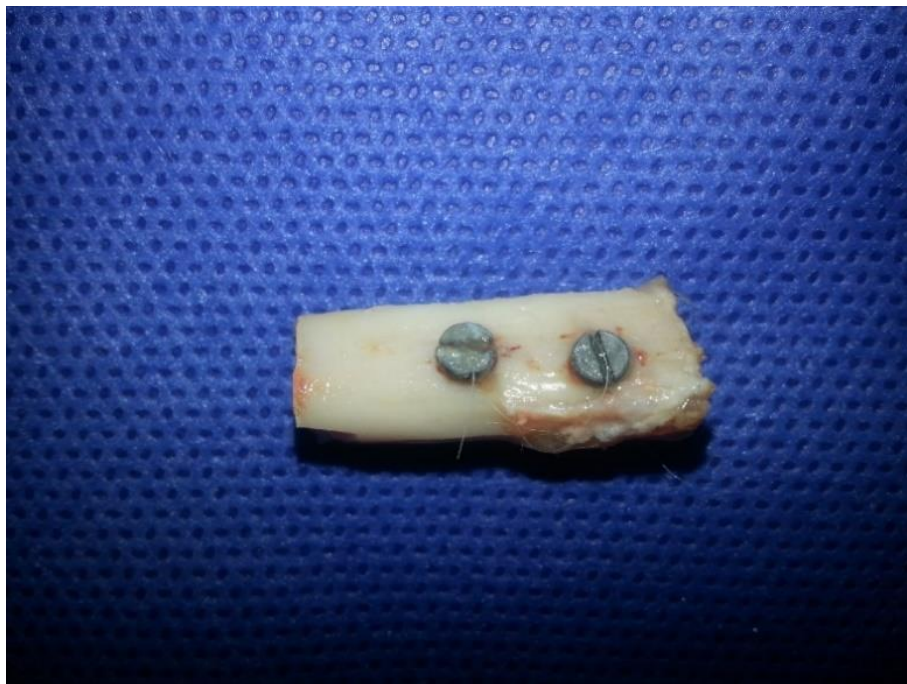
Obr. 22 První odběr, vruty ze slitiny WE43, 4 týdny po implantaci. Oba vruty jsou v místě, kam byly implantovány, pevně v kosti
