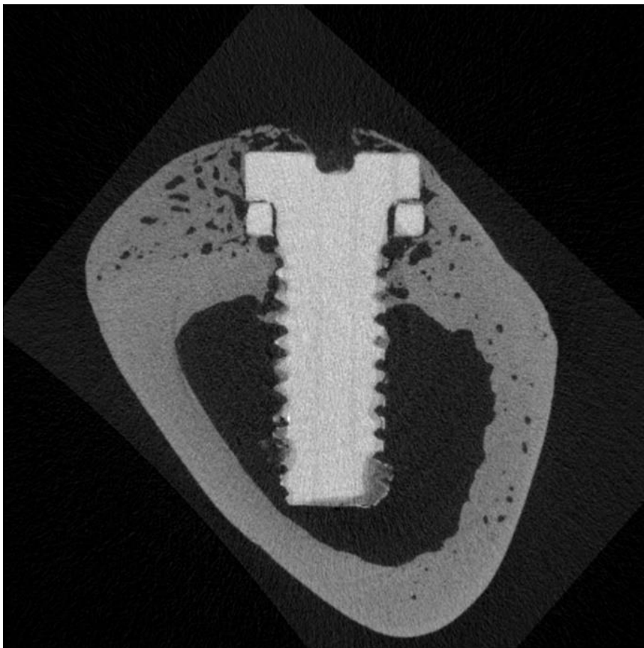
Obr. 29 Implantát ze slitiny WE43, 12. týden, třetí odběr. Implantát je přehožen kostí. Ve větší míře ve srovnání s druhým odběrem dochází k degradaci závitů. Snímek z mikrotomografie
