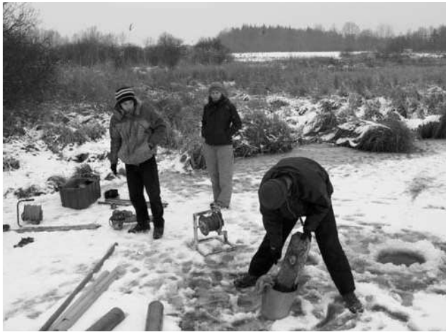
Fig. 3. Winter coring from frozen surface of the Schwarzenberg fish pond. Photo P. Pokorný. — Obr. 3. Odběr profilu jezerními sedimenty ze zamrzlé hladiny rybníka Schwarzenberg. Foto P. Pokorný.
