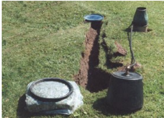
Obr. 2.4.: Podomácku vyrobený perkolační lysimetr se sběrnou nádobou. Upraveno podle Perkins (2022)
