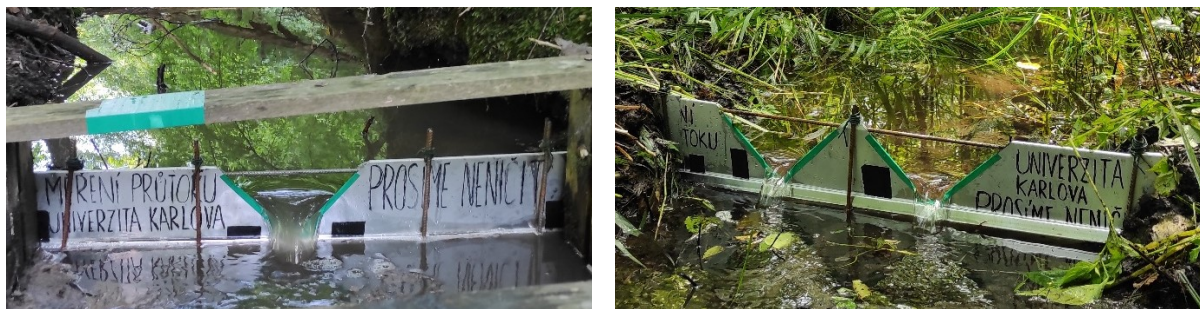
Obr. 3.3: Vytvořený přeliv na Pšovce (vlevo) a přítoku Liběchovky (vpravo) (Foto autor)
