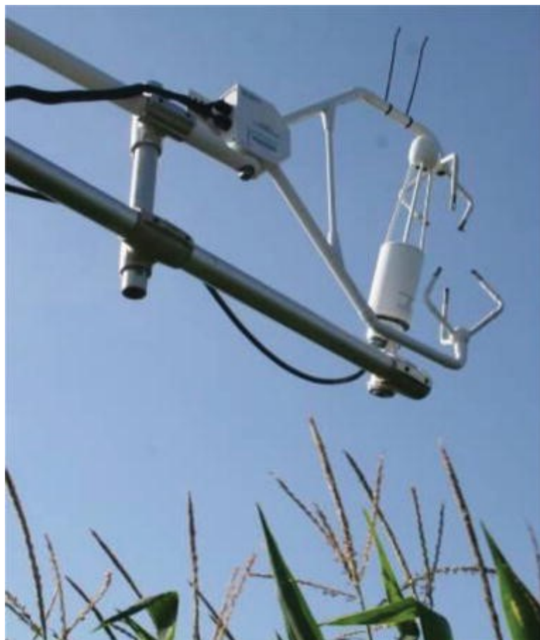
Obr. 2.5.: Sestava pro měření metodou vířivé kovariance – trojrozměrný sonický anemometr a infračervený analyzátor plynů. Upraveno podle Moorhead (2018)
