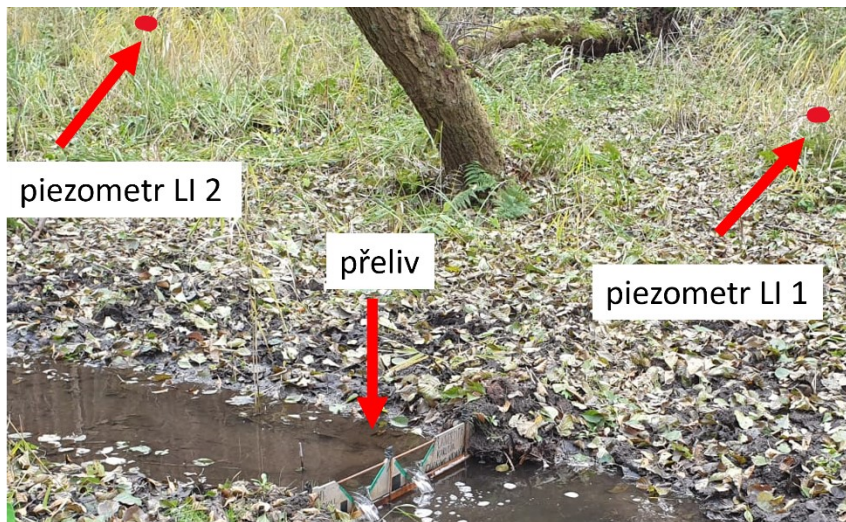
Obr.3.4: Přeliv na přítoku Liběchovky a umístění piezometru LI1, LI2 (Foto autor)
