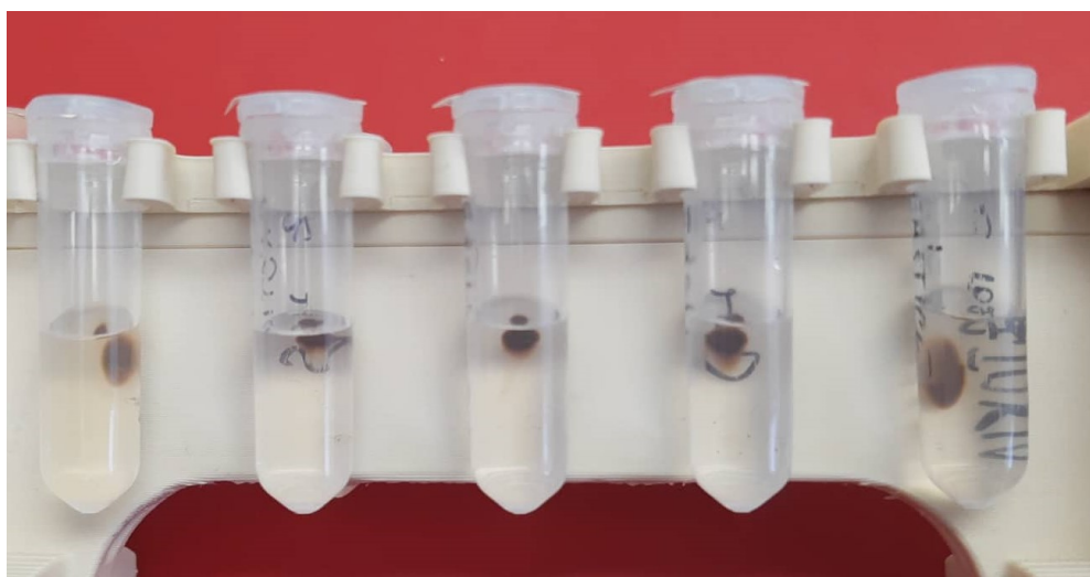
Obrázek 20 Kalibrační řada magnetických částic na magnetickém separátoru
