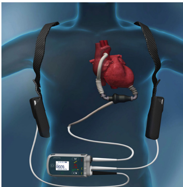
Obr. 1: Schéma ilustrující implantovaný intrakorporální LVAD HeartMate II a externí komponenty systému. Vtoková kanyla je našita do hrotu levé komory, výtoková pak do vzestupné aorty. Čerpadlo je propojeno s řídicí jednotkou (controllerem) pomocí perkutánního vodiče, pomocí napájecích kabelů se zdrojem energie (v tomto případě externí akumulátorové baterie).
