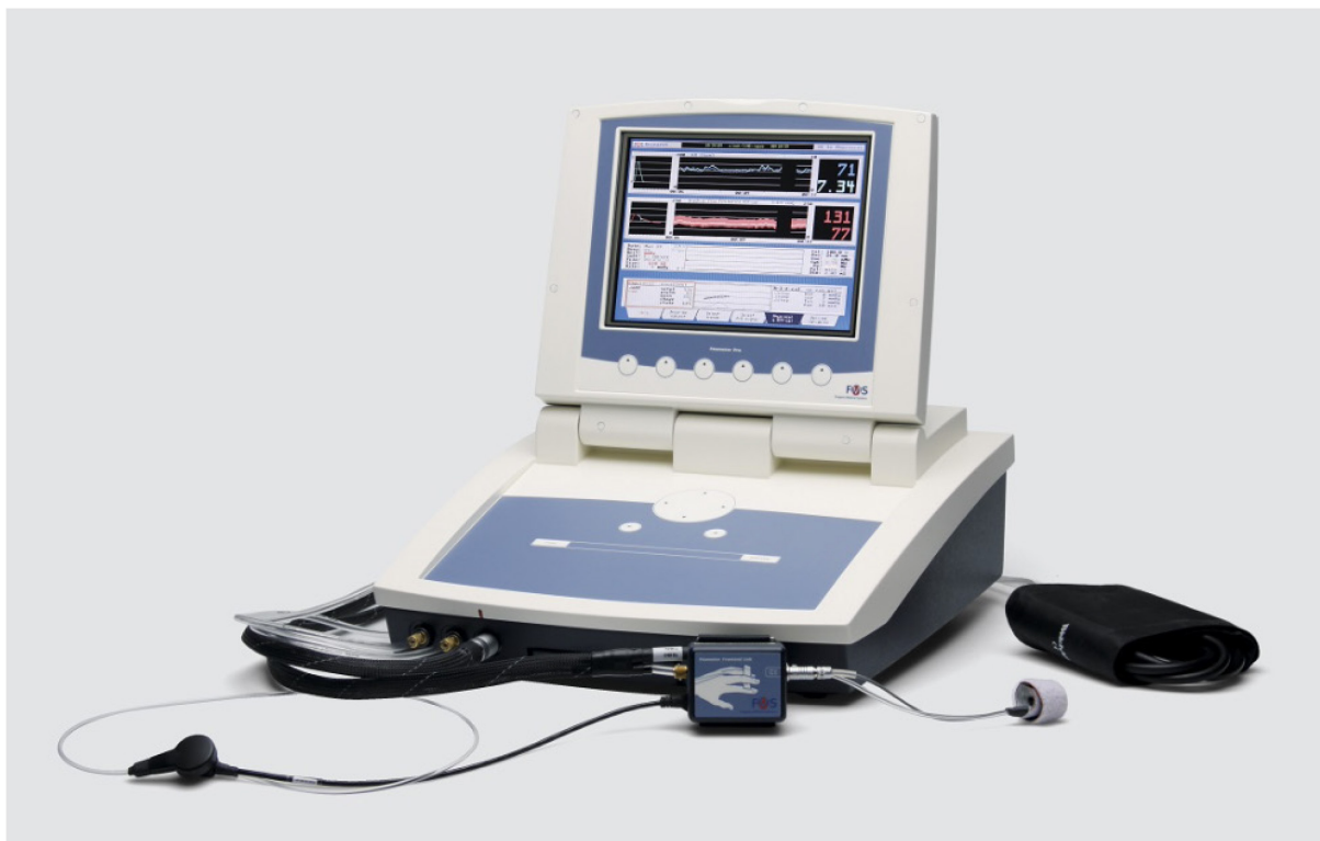
Obr. 3: Finometer Pro (Finapres Medical Systems, Amsterdam, Holandsko) – systém dedikovaný pro neinvazivní kontinuální měření tlaku krve. Systém je založen na tzv. Peňázově principu, kdy je tlak krve v digitálních arteriolách nepřímo měřen za pomoci pulzní oxymetrie v kombinaci s tzv. „volume clamped“ metodou.
