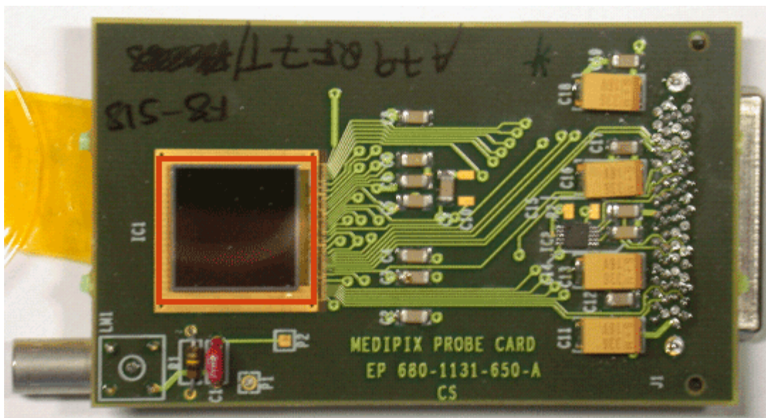
Obrázek č. 9: Elektronický obvod Medipix 2. Detektor je zvýrazněn v červeném rámečku [11].
